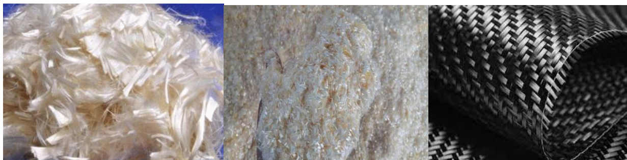
1-rasm Uglerod tola olish uchun ishlatiladigan xom ashyo (Pan tolalari, Pan junlari).
