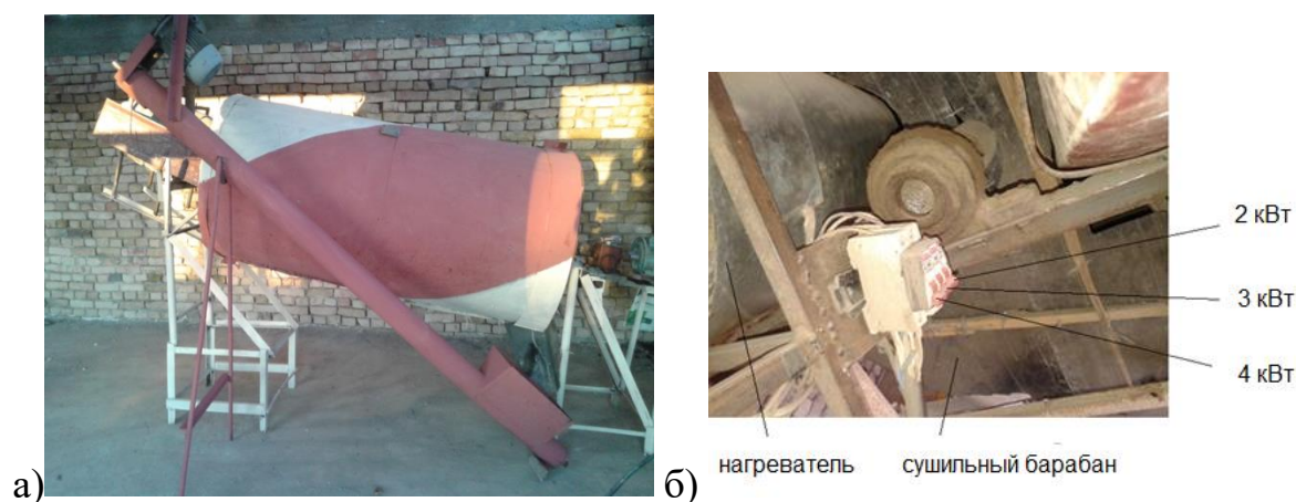
Рисунок 1. а)-Экспериментальный образец зерносушильного устройства. б)- Ключ вариации мощности нагревателя воздуха.
